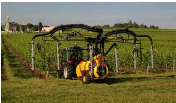
SpeedFlow Progress de Grégoire®, pulvérisateur pneumatique face par face
